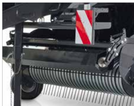
5. Odpružené břity a těžký válec (Ø 217 mm) pro lepší předlisování a tok materiálu
