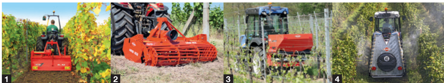
1. Kloubová oj- 2.Rotační brány - 3. Rozmetadla hnojiv - 4. Postřikovač
