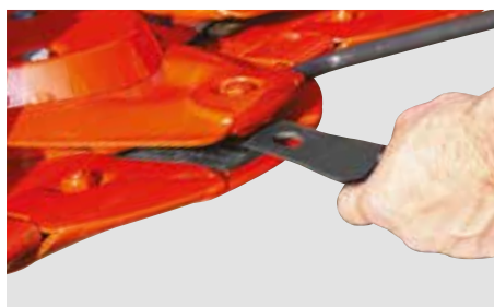
Nože FAST-FIT lze snadno a rychle vyměnit
