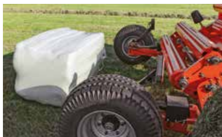
Díky nízko uloženému stolu je zajištěno šetrné vyklopení balíku, takže nedochází k poškození fólie
