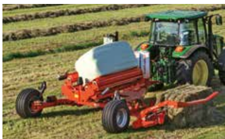
Integrovaná funkce AUTOLOAD baličky SW 1614 C
