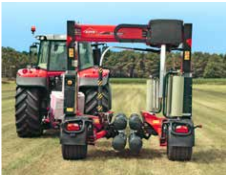
Balička se na poli roztáhne z přepravní polohy o šířce 2,5 m do pracovní polohy o šířce 4 m
