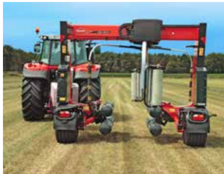
Balička se na poli roztáhne z přepravní polohy o šířce 2,5 m do pracovní polohy o šířce 4 m
