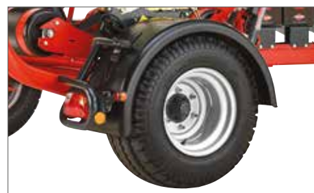
Velké blatníky zabraňují poškození fólie během přepravy
