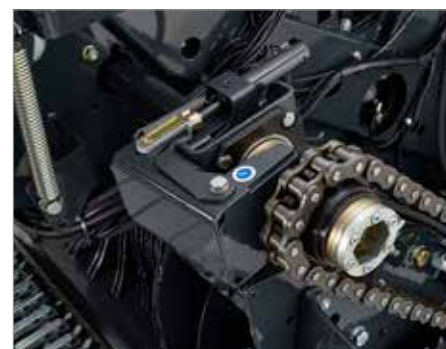
4. Hydraulické odpojení rotoru v základní výbavě
