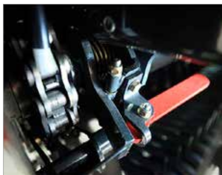
4. Mechanické odpojení rotoru
