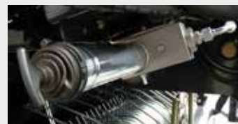
Automatický systém mazání ložisek BEKA-MAX
