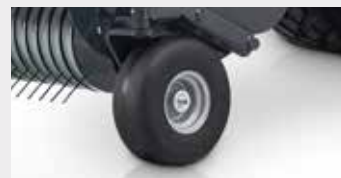
Otočná polopneumatická vodící kola sběrače
