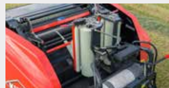
Vázání dvěma fóliemi TWIN-reel film binding
