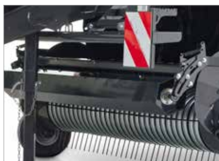
5. Těžký srovnávací váleček (průměr 217 mm) s krytem proti větru
