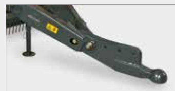
Různé možnosti tažného zařízení včetně kulového závěsu
