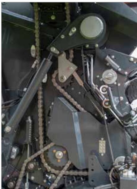
8. Robustní pohonné ústrojí s naddimenzovanými řetězy odolnými proti opotřebení
