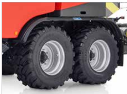
9. Velká tandemová náprava s pneumatikami 500/60R22,5
