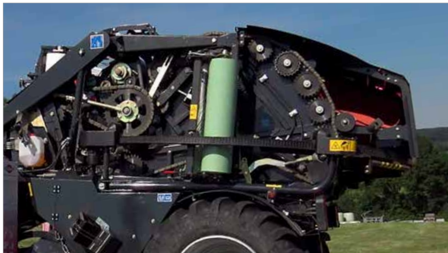
1. Robustní pohonné ústrojí s vysoce kvalitními IWIS řetězy
