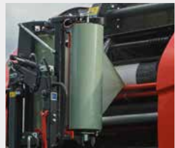
Vázání dvěma fóliemi TWIN-reel film binding
