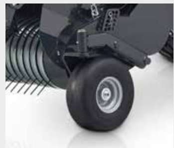
Otočná polopneumatická vodící kola sběrače
