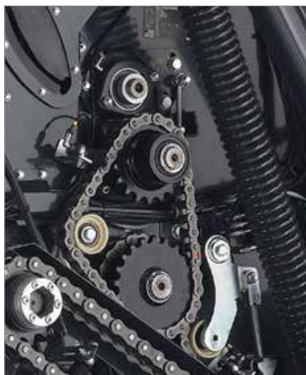
1. Druhý hnací válec pásů zaručuje spolehlivý pohon pásů pro všechny plodiny za všech podmínek
