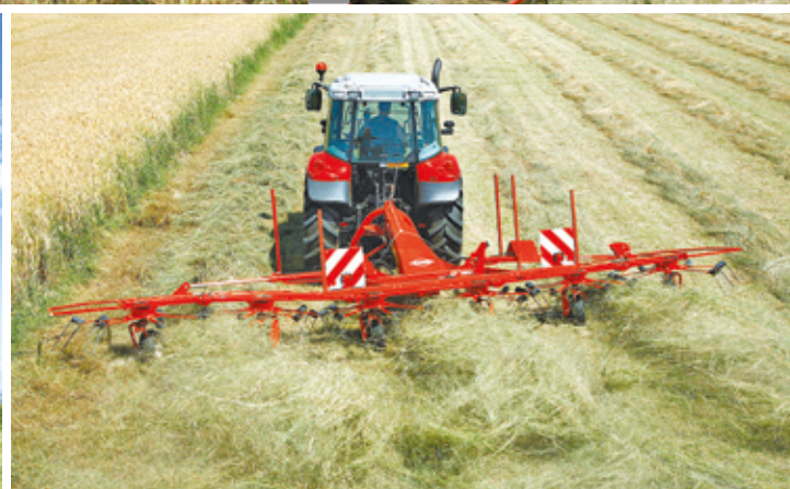
GF 7802 v poloze pro hraniční obracení podél okraje pole.
