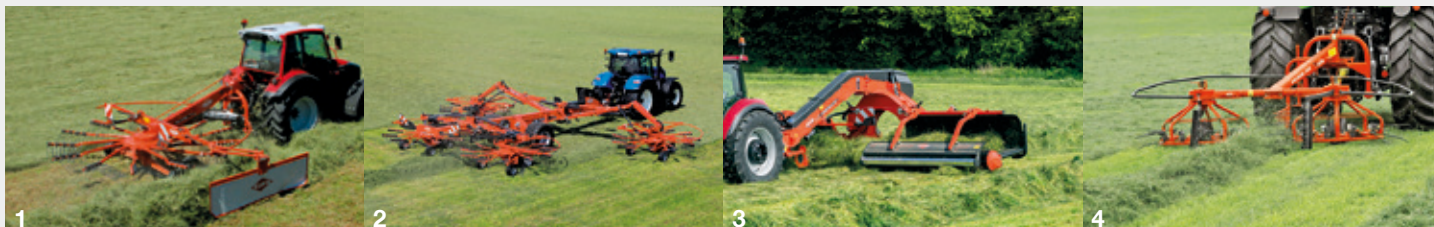
1. Nesené jednorotorové shrnovače - 2. Polonesené čtyřrotorové shrnovače - 3. Pásové shrnovače - 4. Univerzální obrabeče a shrnovače
