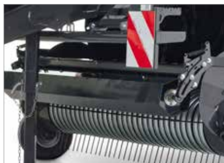
5. Pro lepší předlisování a tok materiálu slouží odpružené hroty a těžký válec (Ø 217 mm)
