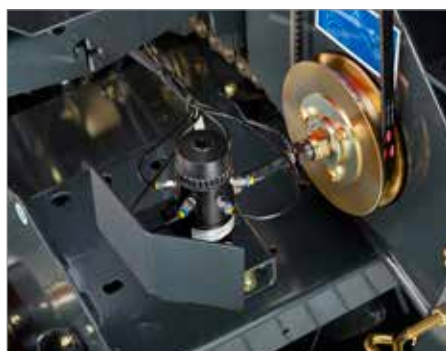
5. BEKA-MAX systém kontinuálního mazání řetězů
