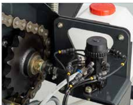
6. BEKA-MAX systém kontinuálního mazání řetězu
