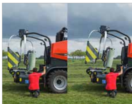
8. VBP 7190: integrované nastavení baličky pro vyložení balíků větších než 1,6 m
