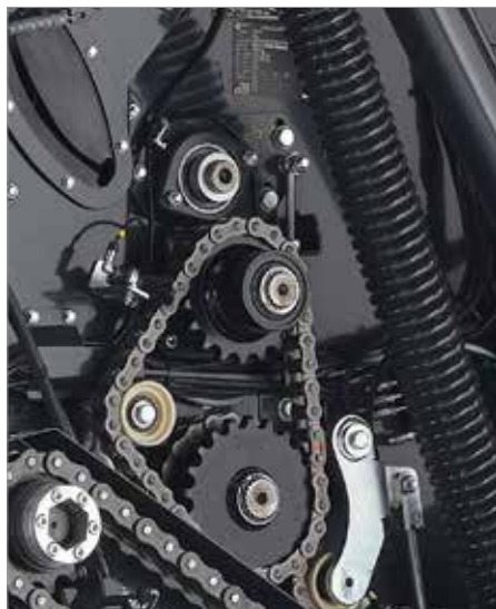
1. Druhý hnací válec zaručuje bezpečnost řemenového pohonu za všech podmínek plodiny
