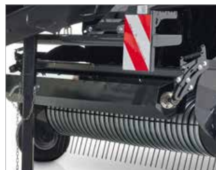
4. Pro lepší předlisování a tok materiálu slouží odpružené hroty a těžký válec (Ø 217 mm)
