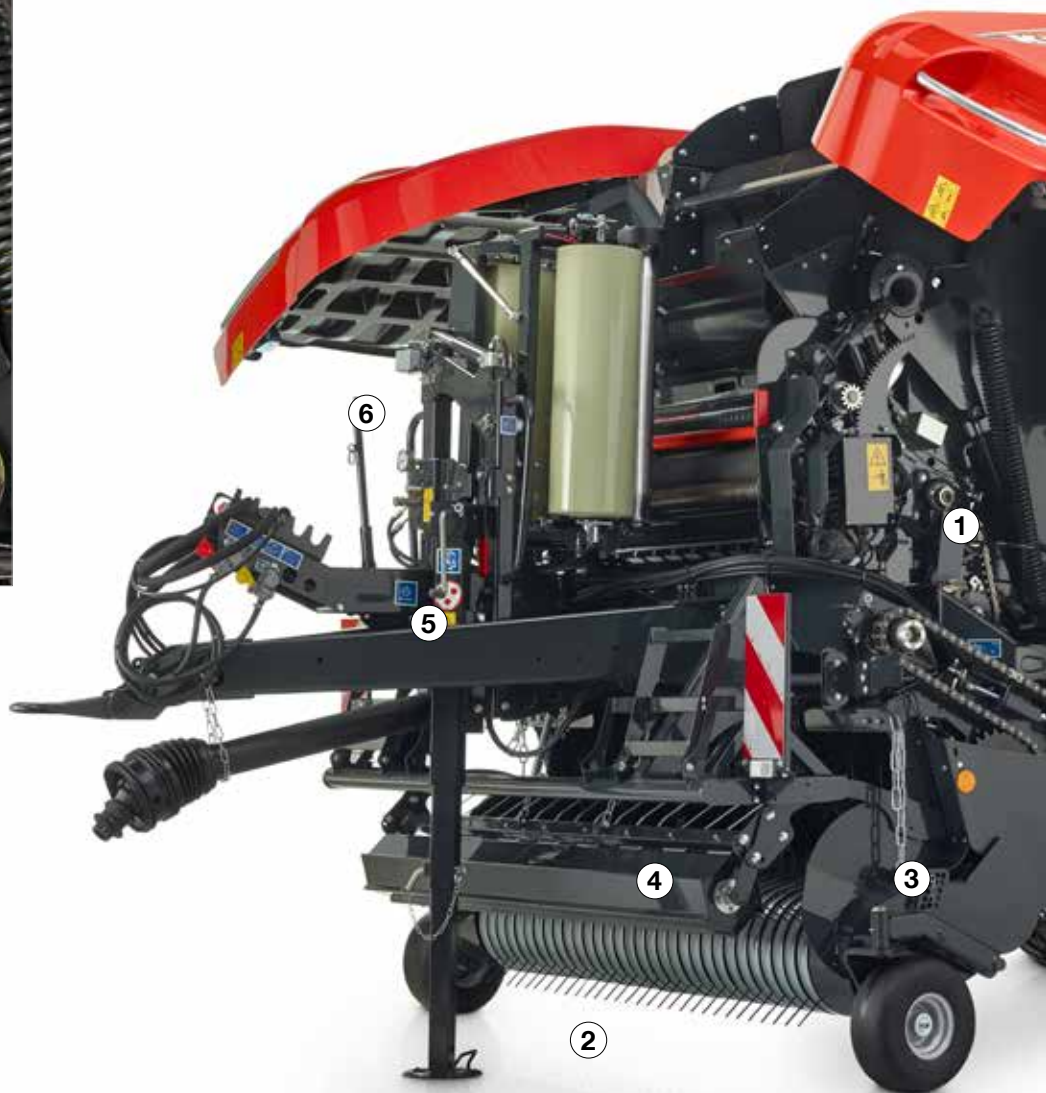
1. Druhý hnací válec zaručuje bezpečnost řemenového pohonu za všech podmínek plodiny
