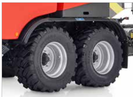
9. Velká tandemová náprava s pneumatikami 500/60R22,5
