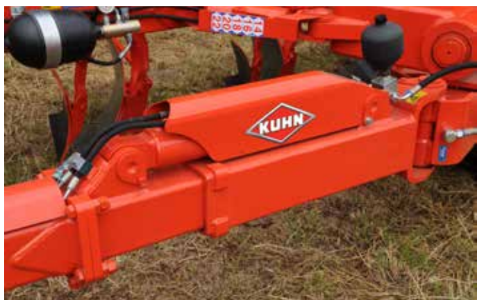
3. Kombinovaným nastavením první radlice a bodu tahu (úhlu pluhu) se obě veličiny nastaví jednou operací pomocí mechanického vřetena nebo pomocí hydraulického válce (na přání). Nastavení usnadňuje přehledná stupnice.
