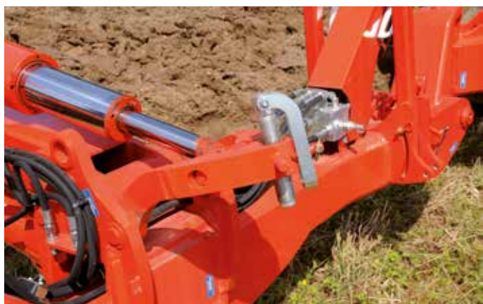
1. Sklon pluhu: pomocí šroubu na levé a pravé straně.
