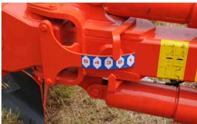
3. Kombinovaným nastavením první radlice a bodu tahu (úhlu pluhu) se obě veličiny nastaví jednou operací pomocí mechanického vřetena nebo pomocí hydraulického válce (na přání). Nastavení usnadňuje přehledná stupnice.
