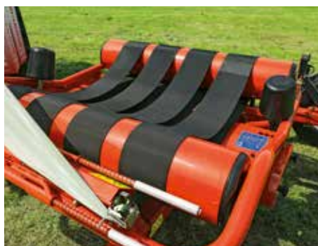
Čtyři rovnoměrně rozložené nekonečné pásy s širokými odstupy
