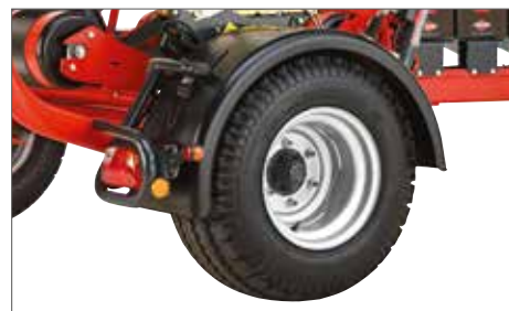
Velké blatníky zabraňují poškození fólie během přepravy
