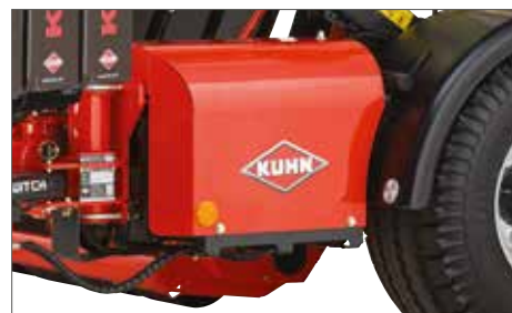
Velký boční kryt chrání hydraulickou jednotku umožňuje snadný přístup při údržbě stroje
