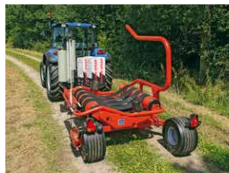
Menší přepravní šířka kvůli nastavitelné poloze kol
