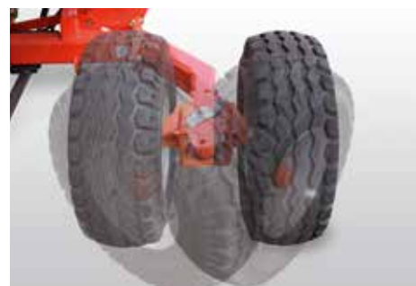
Před jízdou po silnici se pravé kolo může stočit dovnitř. Stočení levého kola je volitelné
