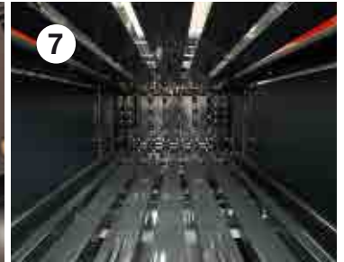
7 3 m lisovací komora s vyhazovačem posledního balíku
