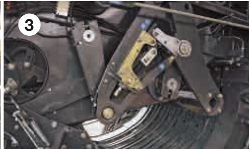
3 Předlisovací komora Power Density
