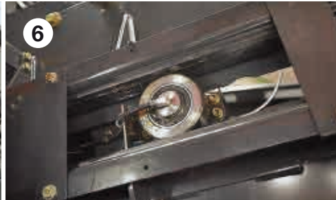
6 Píst o velké kapacitě - 46 zdvihů za minutu, kladky pístu o průměru 12,5 cm.
