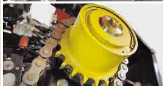
Přetěžovací spojka integrálního rotoru
