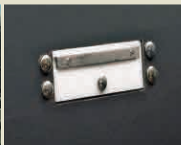
Čidlo vlhkosti integrované v ISO elektronice
