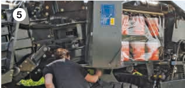
5 Otevíratelný zásobník na špulky s provázkem pro snadnější údržbu
