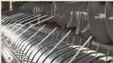
Technologie integraního rotoru zaručuje rovnoměrné intenzivní vkládání materiálu*
