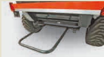
Vyhazovací rampa pro vyšší kapacitu lisování**
