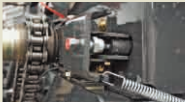
Hydraulická rozpojovací spojka vkládacího rotoru ovladatelná z kabiny traktoru
