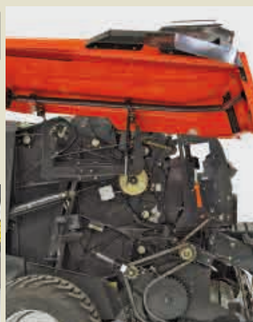
Otevíratelné boční kryty pro perfektní přístup k lisu
