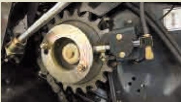
Automatické centrální mazání na přání umožňuje nastavit množství oleje na jednotlivé řetězy
