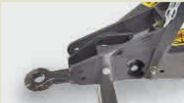
Otočná oj umožňuje snadno přizpůsobit lis do horního či spodního závěsu
