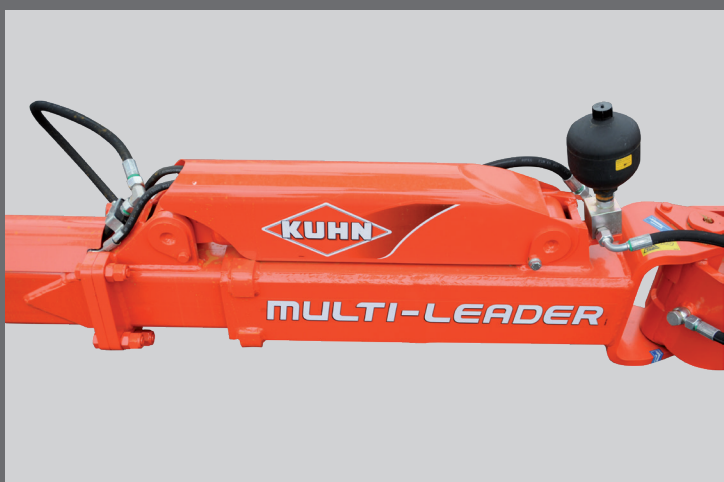
3. Kombinovaným nastavením první radlice a bodu tahu (úhlu pluhu) se obě veličiny nastaví jednou operací pomocí mechanického vřetena nebo pomocí hydraulického válce (na přání). Nastavení usnadňuje přehledná stupnice.
