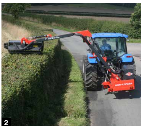
1. & 2. Příkopová ramena s dosahem až 7,40 m - 3. Komunální rozmetadla
