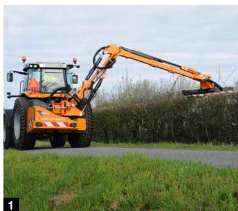
1. & 2. Příkopová ramena s dosahem až 7,40 m - 3. Komunální rozmetadla
