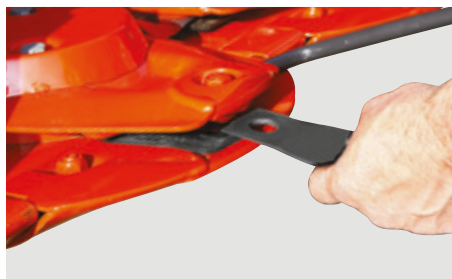
Nože FAST-FIT lze snadno a rychle vyměnit
