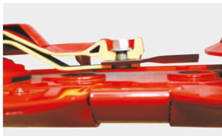
Uchytení rychloupínacích nožů FAST-FIT
